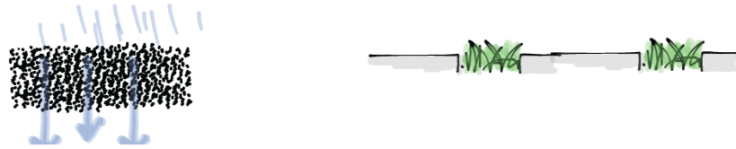
Figur 68. Belægninger med fast og jævn overflade er et krav i BR 10, og det gælder også for permeable belægninger. Græsarmingssten og fliser med store mellemrum til nedsivning som til højre er uegnede for mange med et bevægelseshandicap
