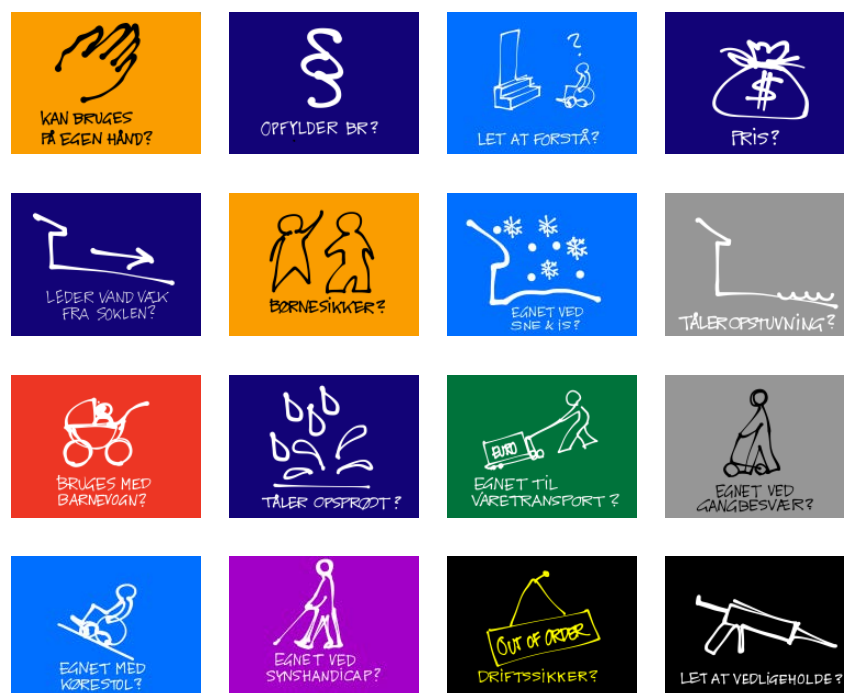
Figur 58. Mange hensyn ved niveaufri indgange. Brugbarhed på egen hånd for fx kørestolsbrugere, synshandicappede, gangbesværede, børn, ældre og måske varettransporter skal parres med bygningsreglementets krav og hensyn til klimapåvirkninger.
